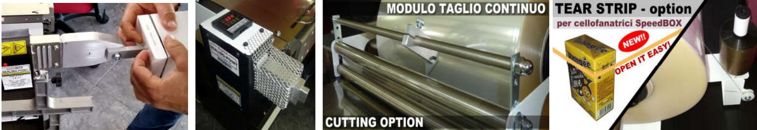
**MÓDULO DE SELLADO DE PUNTOS:** Dé a sus paquetes más elegancia al fijar las solapas del celofán en un solo lugar como en los cosméticos de alto nivel. **MÓDULO DE CORTE:** Ideal para las necesidades de empacar siempre diferentes cajas, permite recortar el exceso de celofán adaptándolo a sus necesidades de muestreo o para restaurar cajas. **DISPENSADOR DE TIRAS:** puede insertar la cinta de apertura rápida típica del paquete de dulces para desenvolver fácilmente el paquete.
